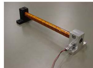
Fig. 7 Magnetorquer
